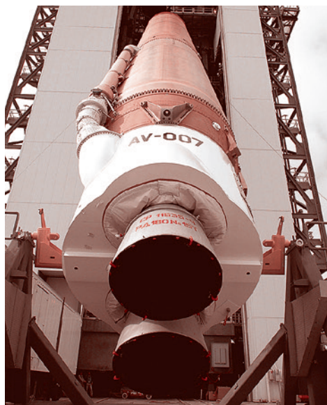
Ракета Атлас-5 с двигателем РД-180
