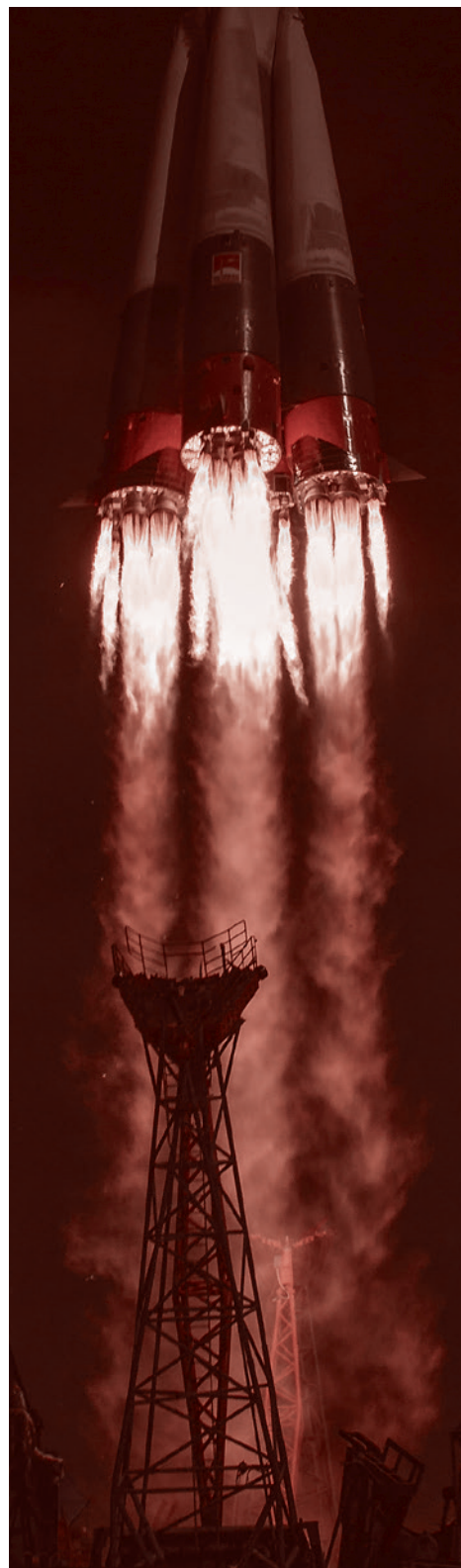
Запуск корабля «Союз МС-10» с двигателями РД-107, использующими керосин в качестве топлива, в качестве окислителя — жидкий кислород. 11 октября 2018 г.
